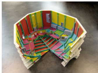
3D Druckmodell aus Polymergips der Elbphilharmonie (Großer Saal) Hamburg © Rapidobject GmbH
