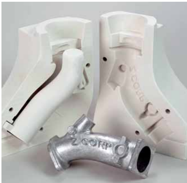
Beim 3-D-Druck wird das Werkzeug in Schichten aufgebaut.
