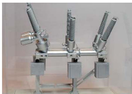
3D Modell »Prototyp Schaltanlage« (mit Selektivem Lasersintern in PA 2200 hergestellt und anschließend metallisiert)
