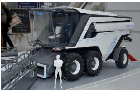
3D Modell »Produktdesign Mährescher« aus dem 3D Drucker (mit Selektivem Lasersintern in Kunststoff hergestellt inkl. Modellbau & Montage der Einzelteile)
